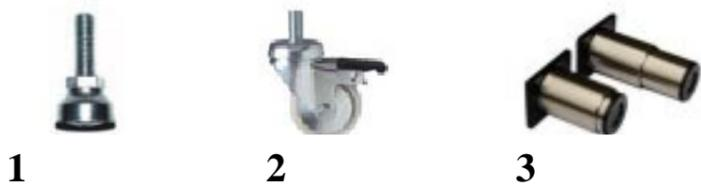
Les comptoirs sont équipés de pieds réglables par l'intérieur de l'appareil, en version standard (1), mais, sur demande, on peut les équiper de roulettes pivotantes avec frein (2) ou de pieds de grands dimensions réglables seulement par l'extérieur de l'appareil (3).
