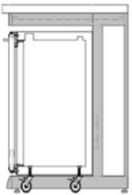
4. vous avez un appareil à insérer parfaitement en dessous de votre paillasse sans devoir modifier la structure. Les dimensions sont parfaites pour l'encastrement soit en largeur 1190 mm, y compris le groupe moteur, soit en hauteur 770 mm y compris les roulettes. L'appareil est équivalent à 2 groupes de tiroirs.
