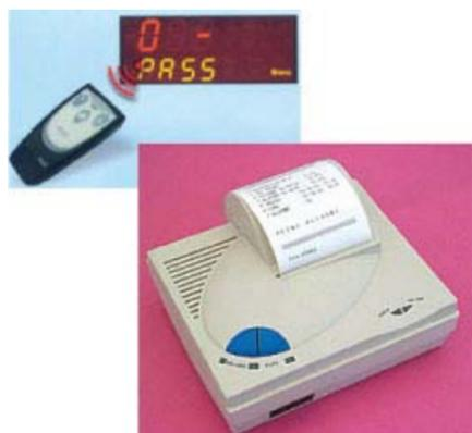
Sur demande on peut avoir un **kit imprimante électronique à rayons infrarouges**, qui permet de recueillir les données enregistrées sur les réfrigérateurs (maximum 40 appareils) pour les imprimer sur une imprimante équipée de porte à rayons infrarouges (protocole IRDA), sans utiliser aucun ordinateur.
