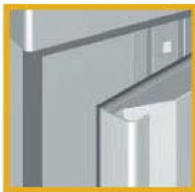
Porta arrotondata **in acciaio inox spessore 10/10, dotata di maniglia inox ergonomica incorporata**, completa di robuste staffe per una facile registrazione della porta. Autochiudente con fermo a 90°.
