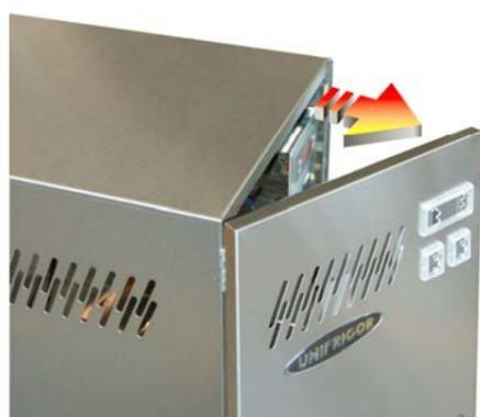
La mascherina copri motore di nuova concezione con apertura laterale, simile a quella di una porta ma con cerniere a libro e chiusura con magnete, facilita l'accesso al vano motore e soprattutto al condensatore, per permettere di effettuare più agevolmente le periodiche operazioni di pulizia.
